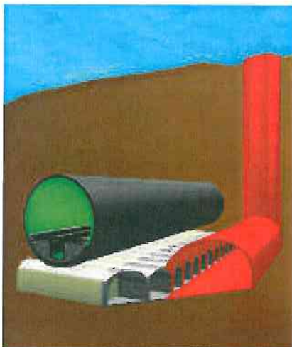
07 Tunnelabschnitt des Projekts «MAULWURF» mit der aus 11 Querstollen bestehenden Knautschzone unter dem Tunnel; Längsstollen und Zugangsschacht (3 Preis IG AEGP, Regensburg)
